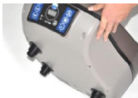
4) Z čerpadla odstraňte zbylou vodu.
